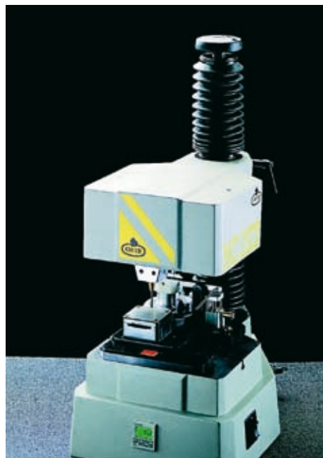
Abbildung Nr. 32 Mit motorisierten Markierkopfverfahrwegen.
